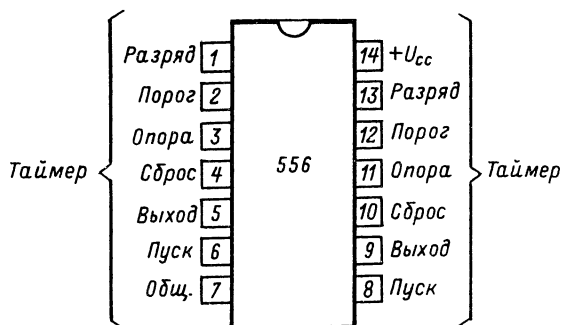
Рис. 6.14. Цоколевка корпуса двойного таймера серии 556
